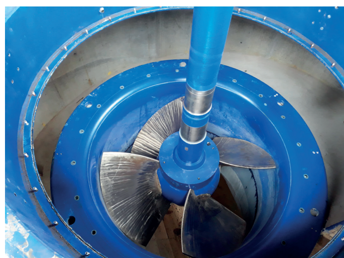
Kaplanlaufrad Durchmesser 2,24 m
